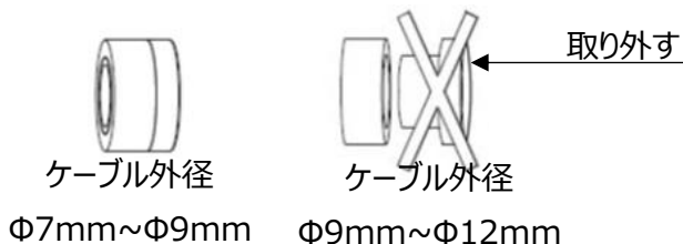
図 3.3 ケーブル外径によるゴムブッシュ選択方法
