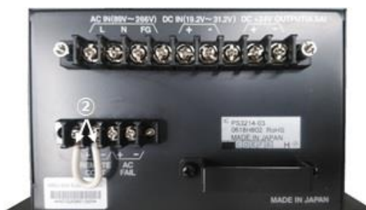
図 E.5 AC・DC 変換器 ジャンパー接続方法（入力電源 DC ありの場合は必須）
