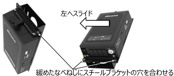
図 2.4 無線機の取付金具へのスライド方法
