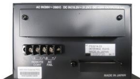
図 E.3 AC・DC 変換器 背面（端子面）保護カバー
