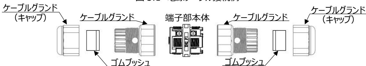
図 3.1 電源ケーブル接続例
