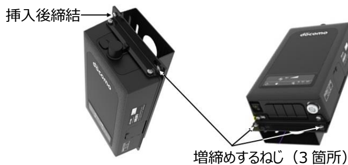
図 2.5 無線機の取付金具への固定方法
