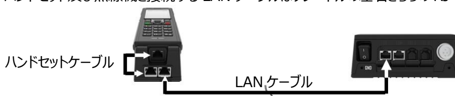
図 2.13 LAN ケーブルの接続方法
