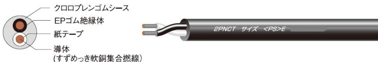
図 C.2 電源延長用ケーブル (2PNCT 2mm 2 )
